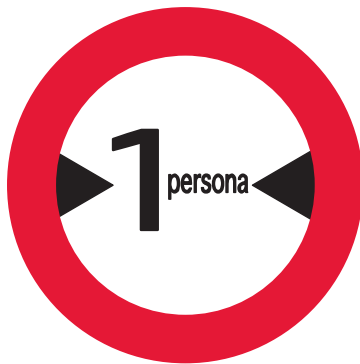
Calzada con limitación de anchura. Ir de uno en uno. No comunitariamente.
